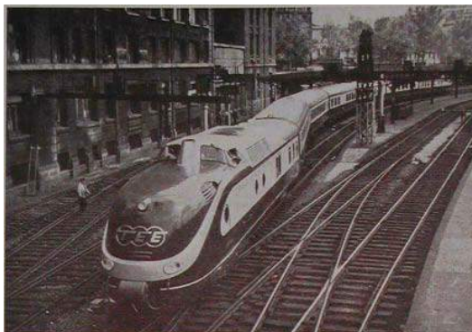
Le Trans-Europe-Express, bien connu des congressistes. Cette rame du type allemand comprend 7 véhicules dont 2 motrices. D'une puissance de 2.660 CV, elle peut atteindre en service une vitesse de 140 km/h. (SNCF)
