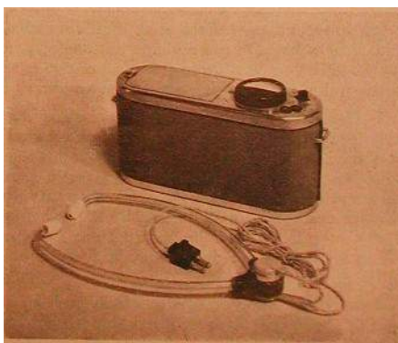
Détecteur de radiations utilisant un circuit à transistors et une pile de 4,5 Volts.
