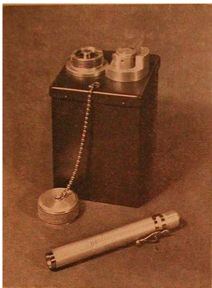
Dosimètre à fibre de quartz et son chargeur, destiné à la protection du personnel.
